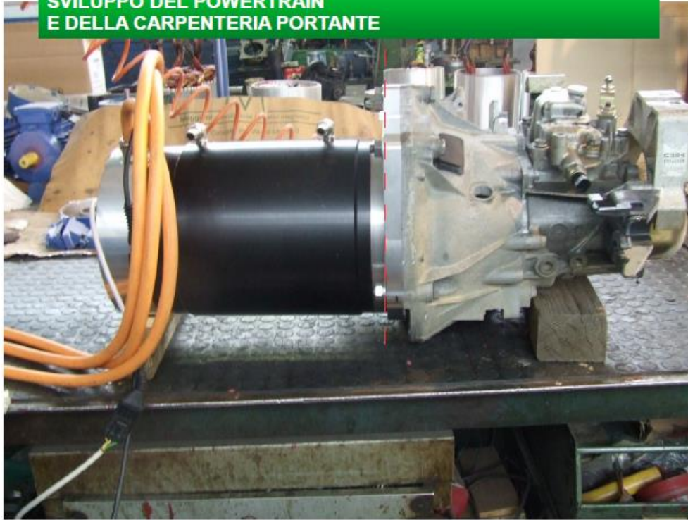
Assemblaggio motore elettrico con campana del cambio originale.
