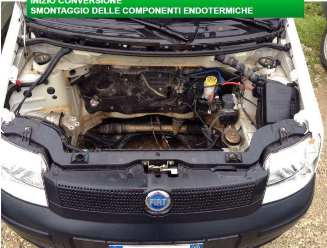
Vano motore liberato dei componenti non utilizzabili.
